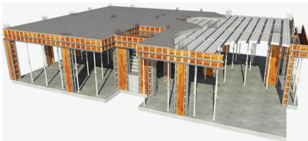
Figura 11 - Escoras metálicas aplicadas em lajes
